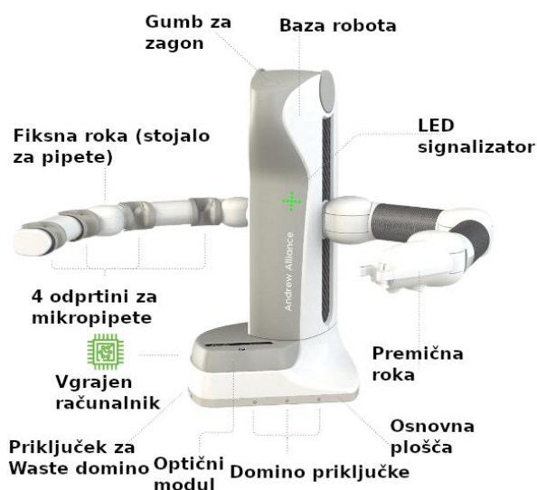
Slika 1: Predstavitev strojne opreme (struktura robotskega mehanizma).
